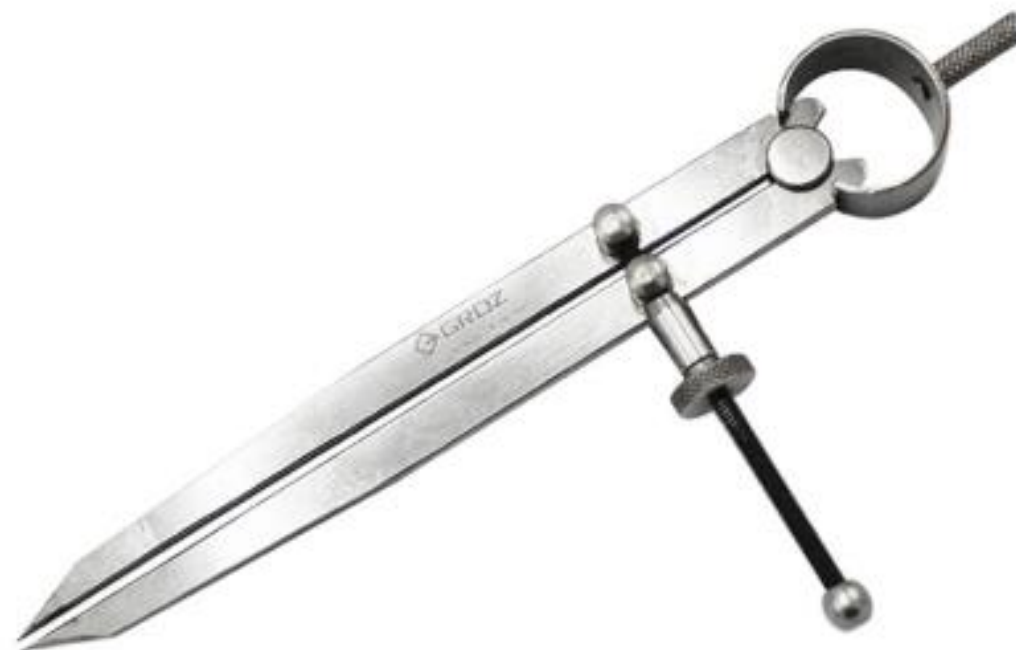
پرگار اندازه‌گیر: برای انتقال اندازه‌ها
